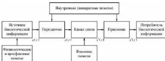
Рисунок 1 – Обобщённая схема передачи информации в БТМС
