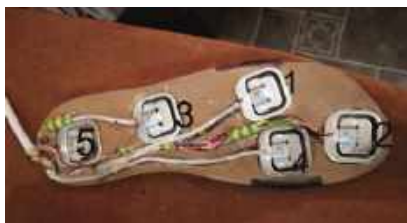
Рисунок 1 - Расположение датчиков на подошве
