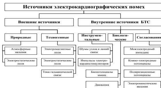
Рисунок 2 – Классификация электрокардиографических помех по источникам формирования
