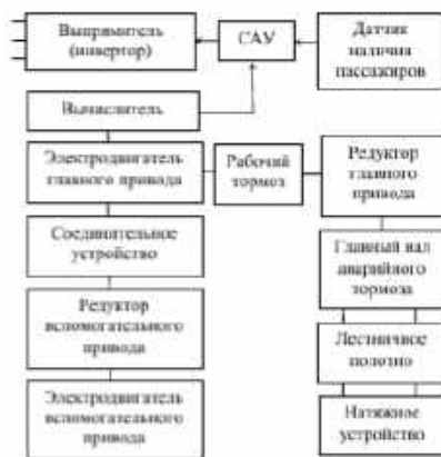
Рисунок 1 –Функциональная схема эскалатора
