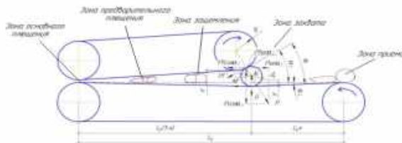
Рис. 2 – Схема зон вальцово-ленточной плющилки.
